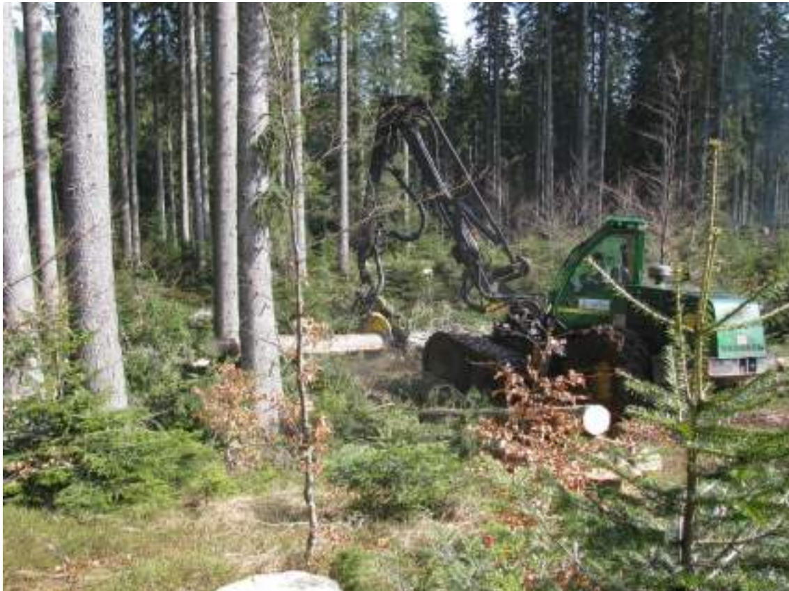
Slika 11: Strojna sečnja omogoča visoke učinke, a je njena uporabnost omejena glede na lastnosti sestoja in rastišča. (Avtor fotografije: Jurij Beguš)
